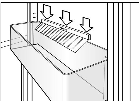
Plastični nastavci držača za boce zadiru u površinu za boce te prilikom otvaranja i zatvaranja vrata uređaja, na taj način bocama pružaju bolju stabilnost.
