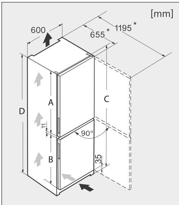
\* Dimenzija bez montiranog dodatka za odmak od zida. Ako se koriste priloženi dodaci za odmak od zida, dubina za ugradnju uređaja povećava se za 35 mm.
